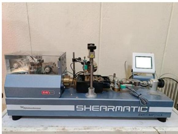
Figure 4 : Machine de cisaillement.
