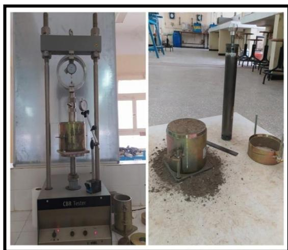
**Figure 4** : Matériels de l'Essai Proctor et CBR
