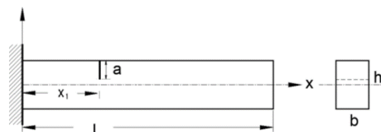
Figure 1: Poutre fissurée en porte à faux
