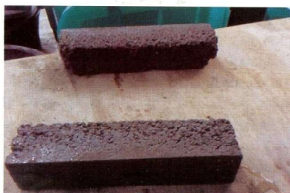
Figure 1 : Etat des éprouvettes avec la pré-formulation adoptée (E/C = 0.50)
