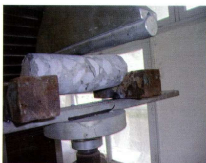
Figure 4 : Carotte extraite du cube soumise à l'essai de traction par flexion
