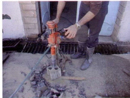
Figure 2 : Extraction, par carottage, d'éprouvettes cylindriques du cube 15x15x15cm (Béton bicouche)
