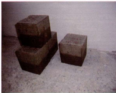
c) Etat des épreuves, 24 h après démoulage, (trace de la reprise de bétonnage au milieu de l'éprouvette).
