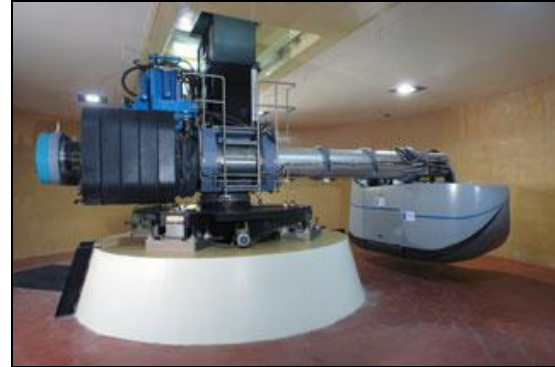
Figure 2 : La centrifugeuse géotechnique de l'IFSTTAR (Ex : LCPC)
