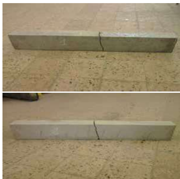
Figure 22 : Exemple de mode de rupture des éprouvettes (12×20×120) cm en flexion
