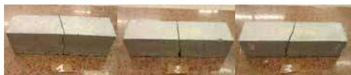
Figure 18 : Exemple de mode de rupture des éprouvettes (7×7×28) cm en flexion
