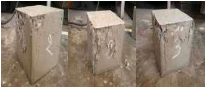
Figure 13 : Exemple de mode de rupture d'éprouvettes (10×10×10) cm modifiés en compression
