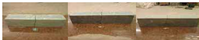
Figure 21 : Exemple de mode de rupture des éprouvettes (12×12×60) cm en flexion
