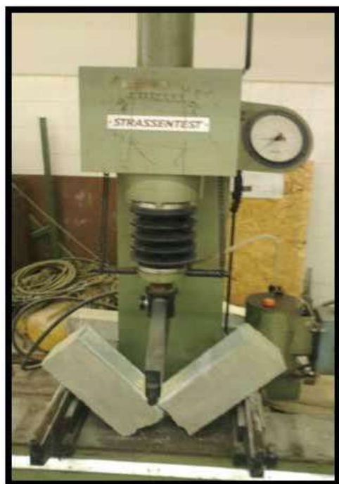
Figure 17 : Eprouvette de dimension (12×12×60) cm rompue sur l'appareil de flexion
