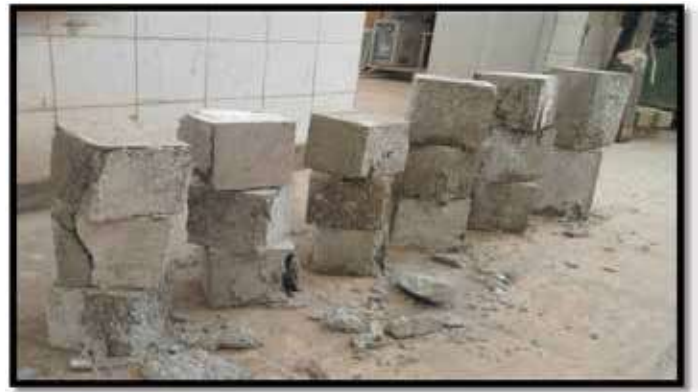
Figure 14 : Autres exemples de mode de ruptures d'éprouvettes modifiées (10×10×10) cm - (12×12×12) cm et (12×12×20) cm
