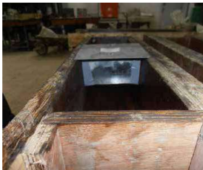
Figure 5 : Emplacement de la fissure au centre du moule avant le coulage du béton Figure 5: Notch emplacement in the centre of mould before casting concrete
