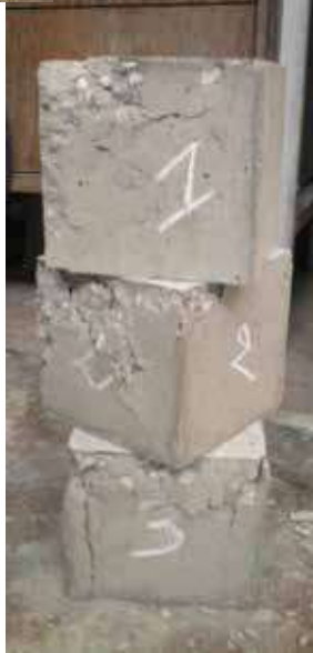
Figure 12 : Exemples de mode de rupture d'éprouvettes (10×10×10) cm normales en compression
