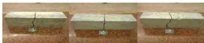
Figure 20 : Exemple de mode de rupture des éprouvettes (10×10×40) cm en flexion
