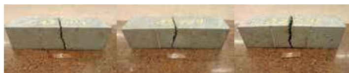
Figure 19 : Exemple de mode de rupture des éprouvettes (10×10×30) cm en flexion
