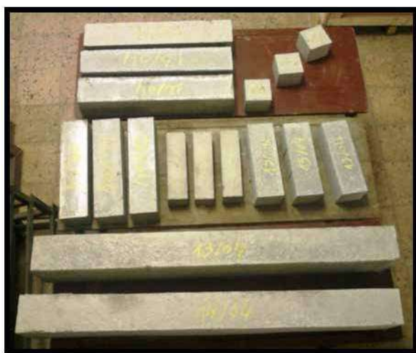
Figure 3 : Géométries des éprouvettes utilisées en flexion Figure 3: Geometries of specimens used in flexure
