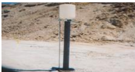
Photo 1 : Dispositif de mesure d'infiltration.
