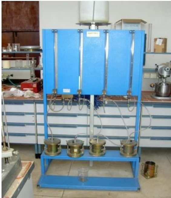
Figure10 : Photographie du dispositif de l'essai de perméabilité avec un perméamètre de compactage
