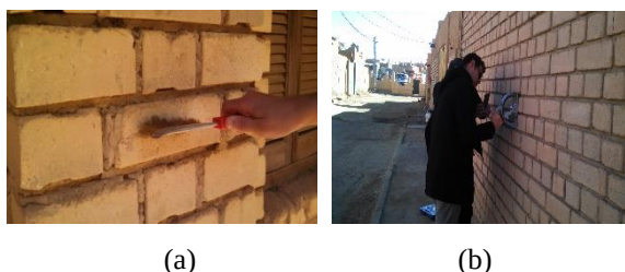
Figure 6 : Essais non destructifs (a) test d'abrasion, (b) essais au scléromètre pendulaire
